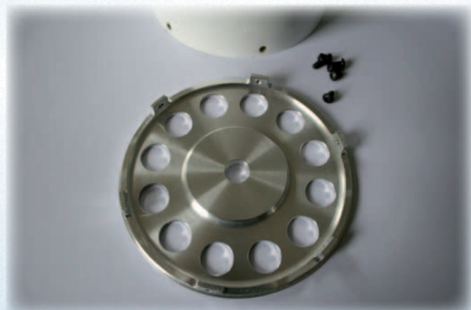
aus einem Stück gedrehte und gefräste Rückplatte aus Aluminium mit diversen Bohrungen zur Gewichtsoptimierung
