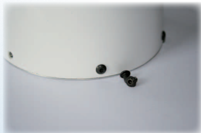
Verschraubung der Spinnerkappe an der Rückplatte
