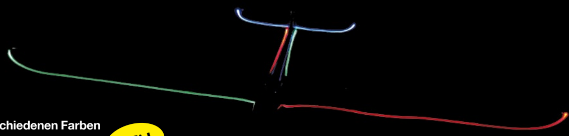
Die LED-Streifen sind nach jeweils 3 LEDs (alle 5 cm) an den Markierungen teilbar. Integrierte Lötunkte machen die Verlängerung einfach.
