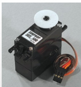
SES-500 2BB-MG Best.-Nr. 010 007 2 Ein kräftiges Servo für universelle Anwendungen. Mit zwei Kugellagern und hochwertigem Poti. Gegenüber dem SES-500 2BB ist dieses Servo mit einem sehr robusten Metallgetriebe ausgestattet, so dass es auch in Anwendungen mit hohen Belastungen, z.B. Lenkung RC-Cars, zum Einsatz kommt.
