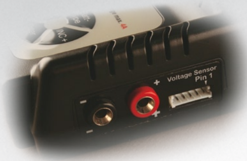
Ladeausgang und der Balancer-Anschluss auf der Seite des Intelli-BiPower NANO
