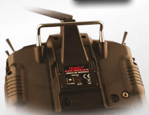
GigaScan JM912 Sendemodul eingebaut in eine MX-22 der Firma Graupner
