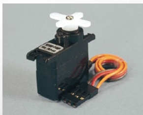
SES-150 BB Best.-Nr. 010 017 0 Sehr kleines präzises Servo mit Kugellager. Ideal geeignet für Modelle mit hohen Anforderungen an Kraft, Geschwindigkeit und insbesondere Ausdauer (häufige bzw. ständige Bewegung während des Betriebs), wie z.B. Elektro 3D-Modelle, Shockflyer und kleine Hotliner. Aufgrund der moderaten Stromaufnahme ist es gut für den BEC-Betrieb geeignet.
