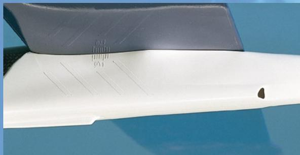
Features: Anti-Rutsch-Sicken, Schwerpunktmarkierungen, Kufe und „Jet typische Anformungen“ für Servoraum und Kühlluftaustritt
