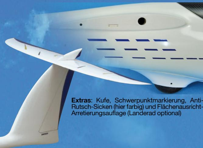
**Extras:** Kufe, Schwerpunktmarkierung, Anti-Rutsch-Sicken (hier farbig) und Flächenausricht-Arretierungsauflage (Landerad optional)
