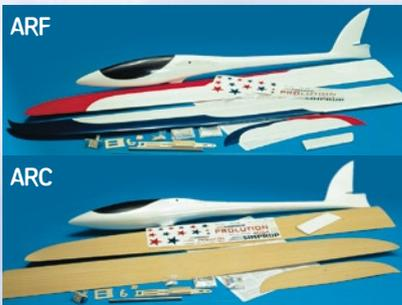
Der andere Lieferzustand ist **ARF**. ARF steht für **Almost Ready to Fly**, was soviel bedeutet wie "fast flugfertig". Grob versteht man darunter, dass die Hauptkomponenten wie Rumpf, Tragfläche und Leitwerk fertig aufgebaut und schon mit Folie bespannt geliefert werden. Der Kunde muss nur noch wenige Montagearbeiten ausführen, seine Fernsteuerkomponenten sowie den Antrieb einbauen und einstellen, und dann geht es schon sehr bald los zum Fliegen.
