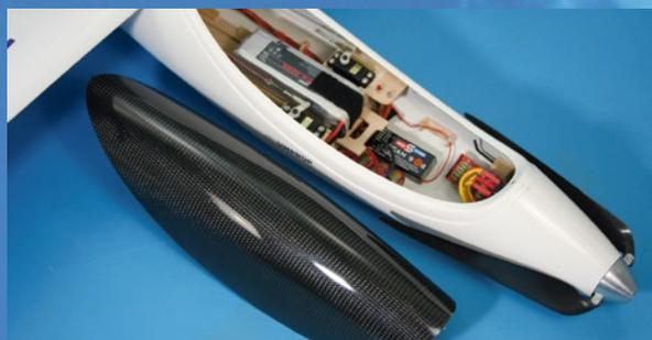
Elektroversion: inklusive aller Einbauteile und verschiebbarer Akkurutsche
