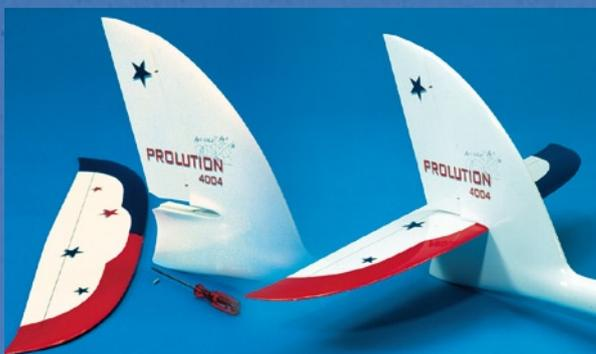
hochfestes, geniales und futuristisches Kreuzleitwerk. Höhenleitwerk profiliert und schraubbar, Seitenruderklappe in GFK mit Hohlkehle
