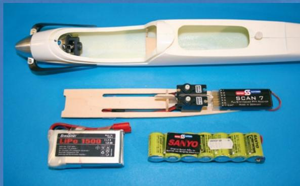
sauberer Einbau mittels Akkurutsche (Akkuwechsel durch die Kabinenhaube)
