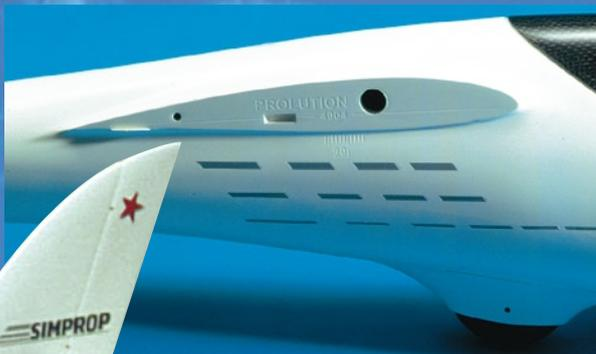
**Extras:** Kufe, Schwerpunktmarkierung, Anti-Rutsch-Sicken (hier farbig) und Flächen-Ausrichtarretierungsauflage
