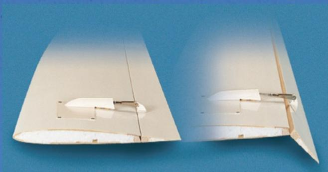
funktionsfertig anscharnierte und spaltfreie Wölbklappen: Anlenkung oben, Drehpunkt unten
