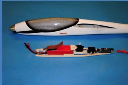
perfekter und raumsparender Akku- und RC-Einbau, Akkuwechsel durch die Kabinenhaube, Akkurutsche zur Schwerpunkteinstellung positionierbar
