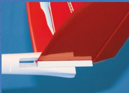
Steckleitwerk mittels Profileiste, Leitwerk zusammenfaltbar und leicht transportierbar
