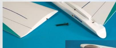
Leitwerk mit Steck-/Schraubbefestigung, selbstausrichtend mit Klemmkonuswirkung
