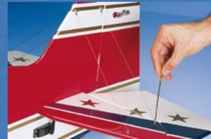
einfache und stabile Montage der Leitwerksverspannungen
