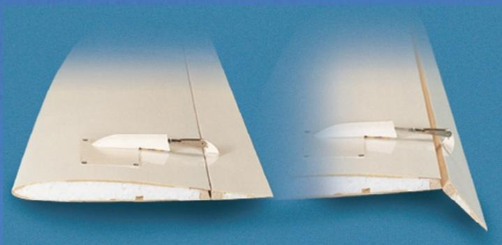
funktionsfertig anschnürte und spaltfreie Wölbklappen: Anlenkung oben, Drehpunkt unten
