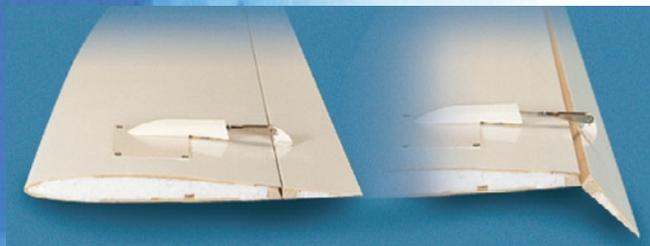
Wölbklappen: Anlenkung oben, Drehpunkt unten
