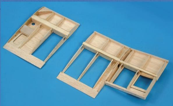
konsequente High-Tech Rippenbauweise in Lasertechnik, mit GFK-Flächenverbinder
