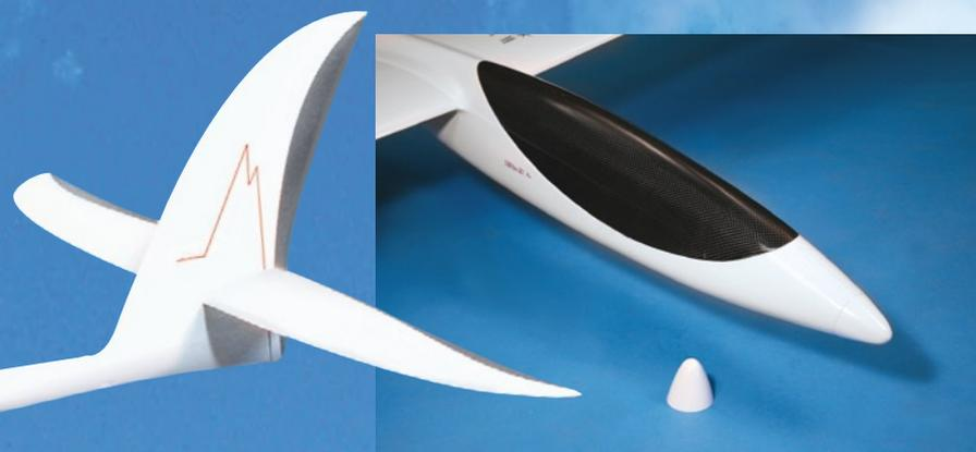
**auch als reiner Segler ein echter Hingucker:** optional kann der Streamtec XL mit der passgenau gefertigten GFK-Seglernase (Best.-Nr. 031 379 3) ausgestattet werden
