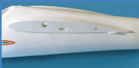
Extras: Kufe, Schwerpunktmarkierung, Anti-Rutsch-Sicken und Flächen-Ausrichtarretierungsauflage
