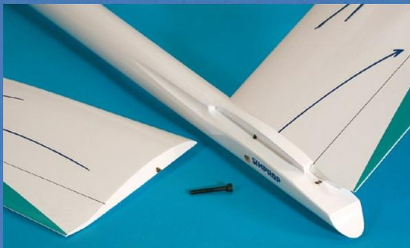
Leitwerk mit Steck-/Schraubbefestigung, selbstausrichtend mit Klemmkonuswirkung
