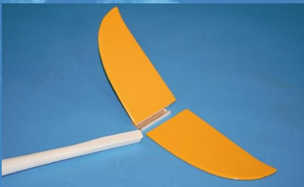
einfachste Leitwerksverklebung mittels profilierter Leiste
