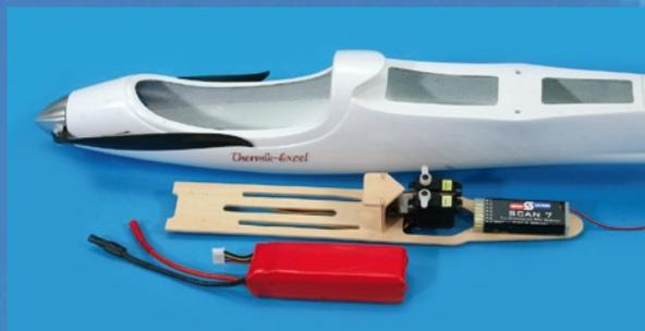
perfekter RC- und Akkueinbau (Akkuwechsel durch die Kabinenhaube)
