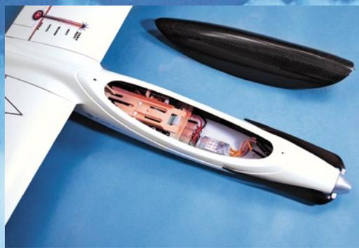
inklusive aller Einbauteile und verschiebbarer Akkurutsche zur Schwerpunkteinstellung
