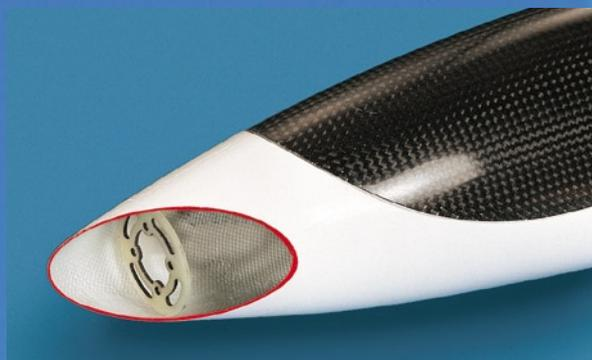
Motorspant fertig eingeharzt
