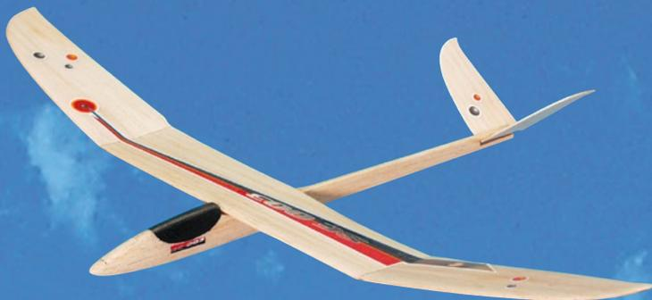
In optischer Anlehnung an das DMFV-Wettbewerbsmodell SE 300 wurde dieser Wurfgleiter der neuesten Generation entwickelt. Die doppelte V-Form und die Tiefensprünge der Tragflächen sowie die V-Form des Leitwerks finden sich wieder. Rumpf und Flächenprofil ermöglichen optimale Flugergebnisse.
