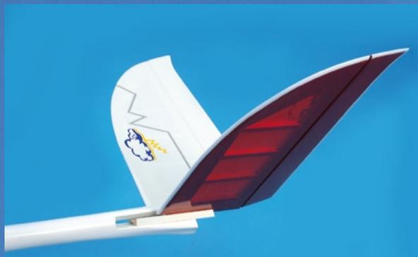
geniales Steckleitwerk mittels Profilleiste
