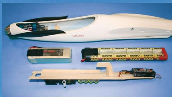
raumsparender Akku- und RC-Einbau, Akkuwechsel durch die Kabinenhaube, Akkurutsche zur Schwerpunkteinstellung verschiebbar
